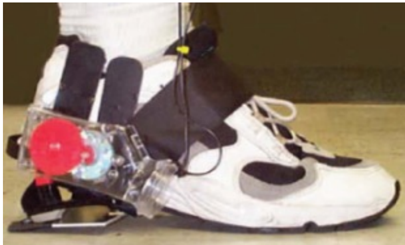
Magnētiskais ģenerators, 250mW (MIT Media Lab)
