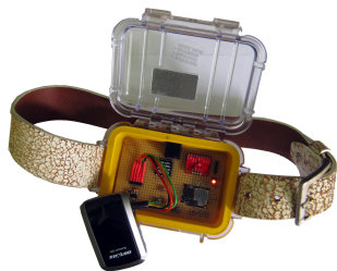
Att. 3.2.: Sākotnējā gala iekārta
